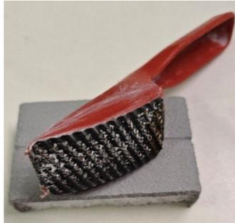
Stirnseitige Sichtflächen um ca. 3-4 mm zurückkratzen und anschliessend mit applik Profilkleber bündig verspachteln. Sichtkanten mit Raspel gerundet anschleifen.
